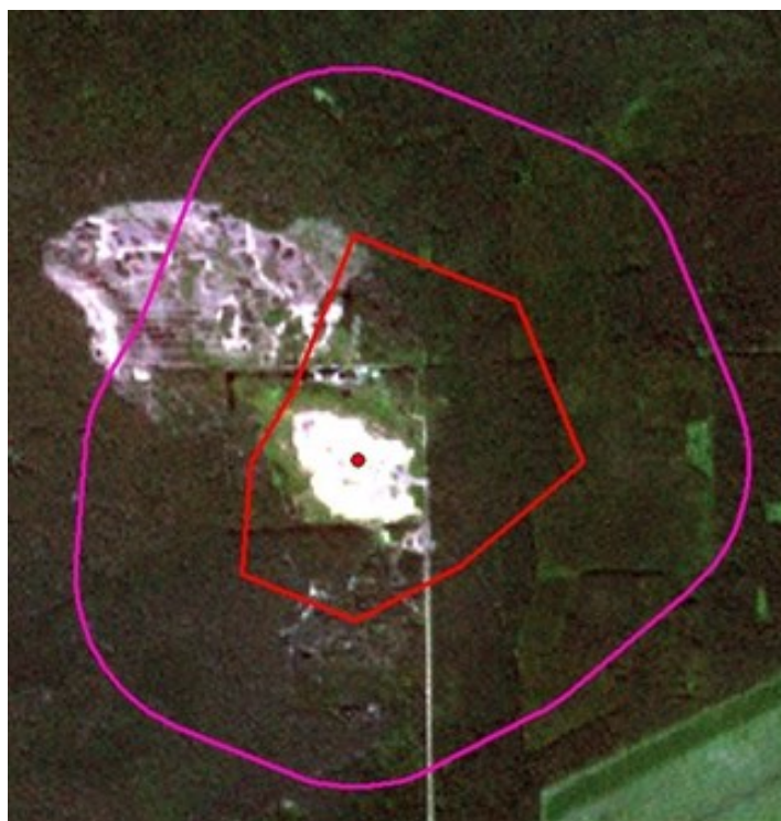
Рис. 2. Пример построения СЗЗ (красным цветом) и буферной зоны вокруг нее (розовым)
