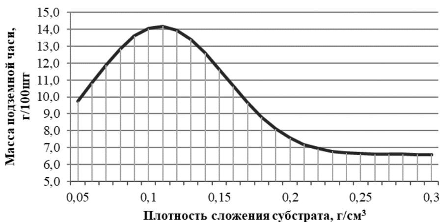
Рис. 2. Зависимость показателей массы подземной части сеянцев сосны обыкновенной от плотности сложения субстрата
