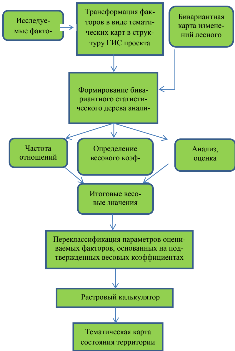
Рисунок 3.18 – Алгоритм разработки ситуационной карты
